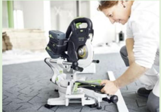
**Trasferimento dell'angolo senza errori.** La regolazione precisa dell'angolo sulla KAPEX permette di trasferire l'angolo di taglio desiderato assolutamente senza errori con la falsa squadra.
