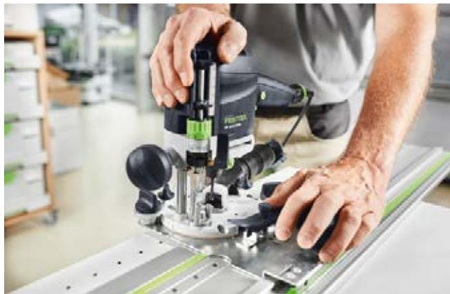
**Fori in serie.** Con la OF 1010 R e il sistema di foratura LR 32 si possono realizzare serie di fori per supporti di ripiani e pareti o cardini in modo semplice, efficiente e rapido.
