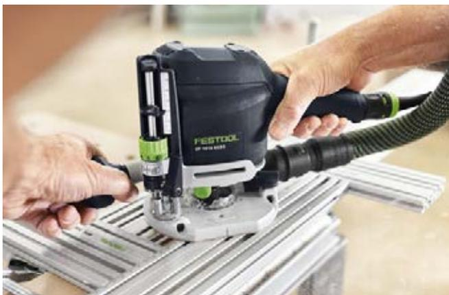
**Tagli di apertura e raggi precisi.** La multidima di fresatura MFS 400 si fissa con precisione e rapidità sia sulla superficie sia nell'area dei bordi: perfetta per cerniere o cardini. Si presta in modo eccellente anche per fresature circolari.
