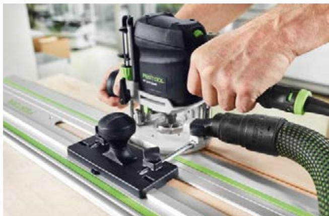
**Ostinatamente dritti.** Con l'adattatore per il binario di guida della fresatrice e il binario di guida sono garantite fresature drittilissime, come per es. scanalature, se necessario, anche di più metri.
