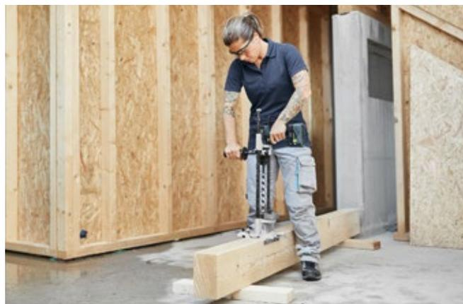
**Serrare a mano.** Il mandrino a serraggio rapido è posizionato sulla macchina senza attrezzi e viene bloccato a mano. Con una range di serraggio da 1,5 a 13 mm, è possibile eseguire anche lavori di foratura estremi.
