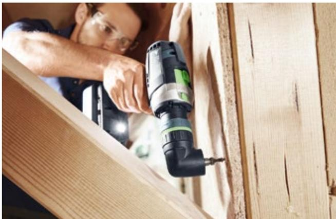
**Avvitare "dietro l'angolo".** L'attacco angolare ruotabile mostra i suoi punti di forza quando, durante la foratura o l'avvitamento, c'è carenza di spazio. Ed è davvero forte, anche alle coppie più elevate.
